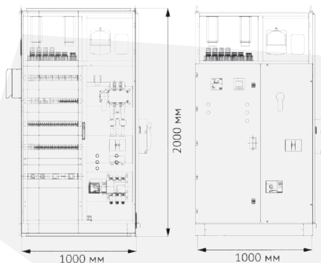
Вводно-распределительное устройство вид спереди
